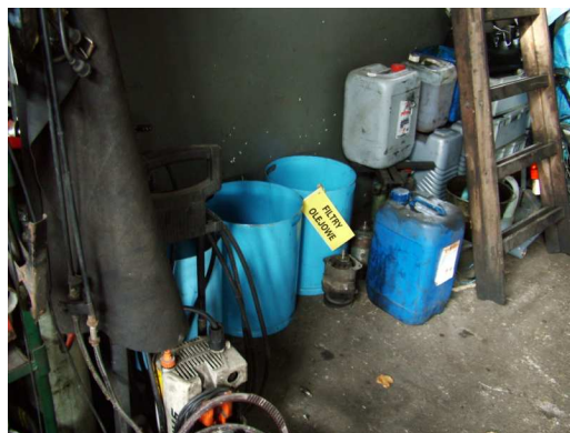
Brak pojemników na poszczególne rodzaje odpadów - pojemniki nieoznakowane
